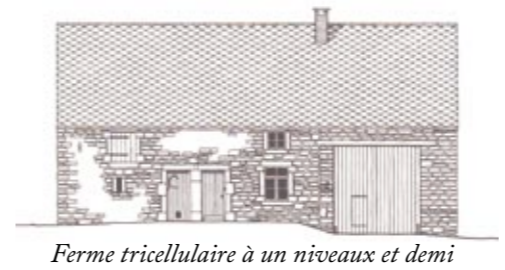
Ferme tricellulaire à un niveau et demi
